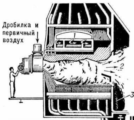
Рис. 4.10. Горизонтальный предтопок:
